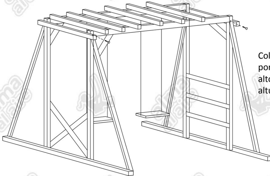
Colocar 2 bulones pasante por cada encastre. Ajustar el alto de las hamacas a la altura deseada
